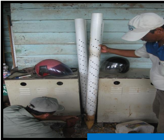
Alat Ukur Piezometer dipasang didalam blok sebanyak 3 titik
