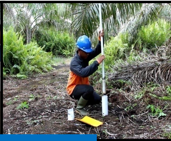
Alat Ukur Piezometer dipasang didalam blok sebanyak 3 titik
